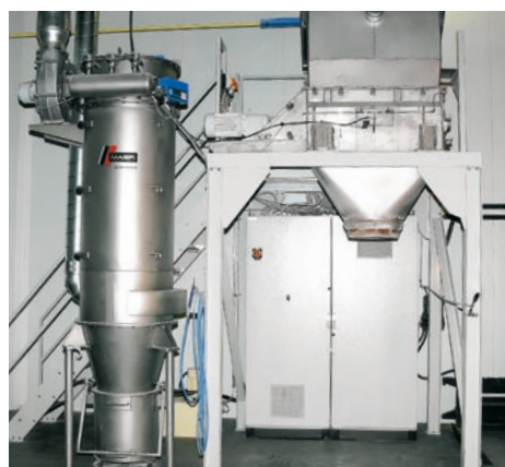
Entsprechend der Rezeptur werden in der Aufschüttanlage die Zutaten zusammengestellt
