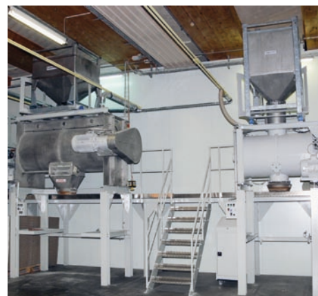
Zwei Gegenstrommischer sorgen für homogene Mischungen der Stabilisierungssysteme
