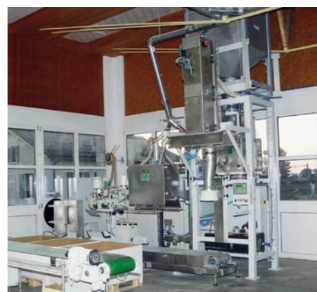
Die Absackanlage füllt automatisch die Stabilisierungssysteme ab
